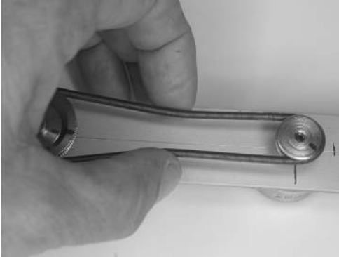
Abb. 3.28: Die richtige Riemenspannung, ist wichtig für den Erfolg!
