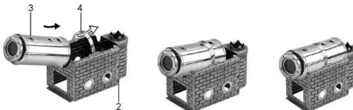
Abb. 2.2.1: Montage des Kessels
