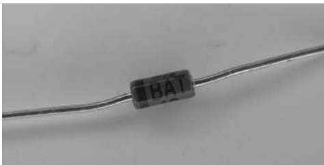
Abb. 3.14: Schottkydiode, Typ BAT 48. Die Kathode der Diode ist an dem aufgedruckten schwarzen Ring zu erkennen, der andere Anschlussdraht ist die Anode. Die technische Stromrichtung geht von der Anode zur Kathode
