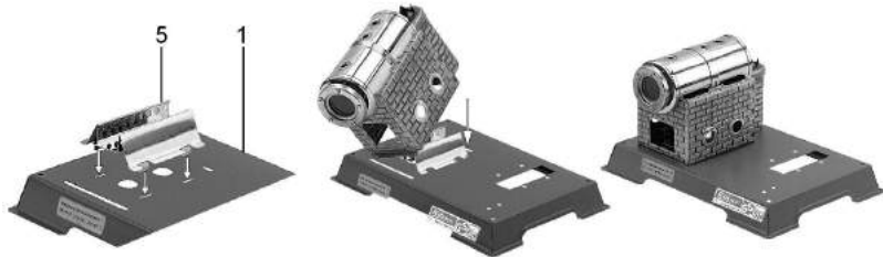
Abb. 2.2.2: Brennerführung und Kesselhaus montieren
