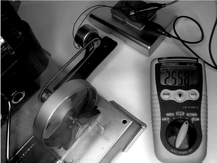
Abb. 3.29: Messen der Generatorspannung mit dem Multimeter, Messaufbau
